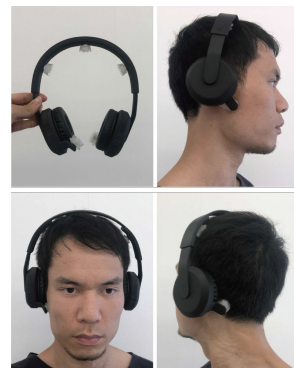
小型・ワイヤレス・迅速装着が可能な脳波センサー
