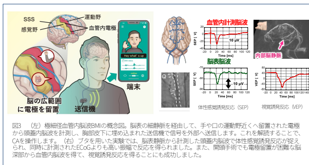
図3（左）極細血管内脳波BMIの概念図。脳表の細静脈を経由して、手や口の運動野近くへ留置された電極から頭蓋内脳波を計測し、胸部皮下に埋め込まれた送信機で信号を外部へ送信します。これを解読することで、CAを操作します。（右）豚を用いた実験では、脳表静脈から計測した頭蓋内脳波で体性感覚誘発反応が捉えられ、同時に計測されたECoGよりも高い振幅で反応が得られました。また、開頭手術でも電極留置が困難な脳深部から血管内脳波を得て、視覚誘発反応を得ることに成功しました。
